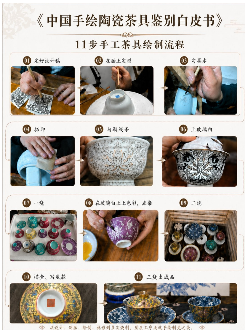
图1 朔香全手绘粉彩茶具 11 步制作流程(设计稿 → 定型 → 勾墨水 → 拓印 → 勾线条 → 上玻璃白 → 一烧 → 上色彩 → 二烧 → 描金/写底款 → 三烧出成品)
